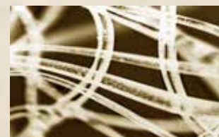
Вертикально-горизонтальное расположение полых волокон ОГНЕСТОПа также позволяет удерживать больше воздуха между ними
